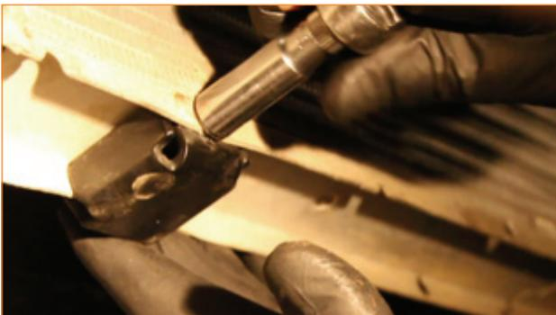
7. Using your fan removal tool, loosen the fan nut.
